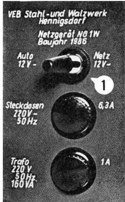
**Bild 10** Frontplatte Netzgerät
